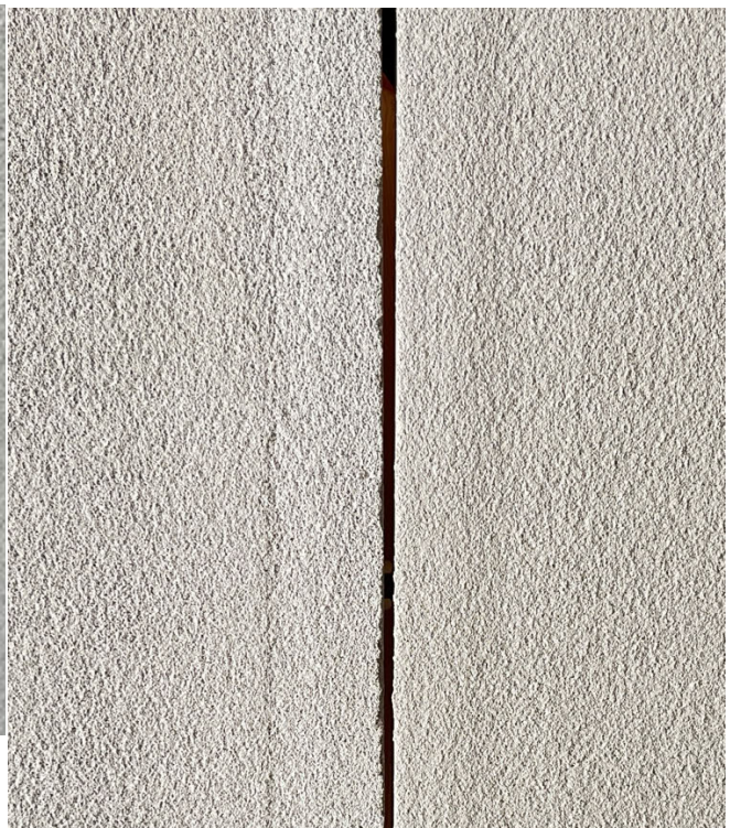
11: Unregelmäßigkeit in der Kante, andere Oberflächenstruktur im Randbereich
